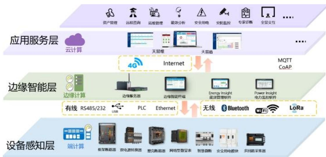
智能配电系统，是将互联技术与配电系统紧密结合，集硬件、软件和服务于一体，具有开放、交互和基于物联网平台的智能系统。
